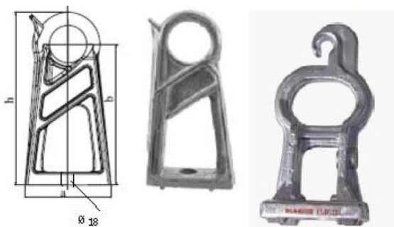
Figura 15-10: Aksesor per fiksimin e tirantuesit ankeror ne qafore
