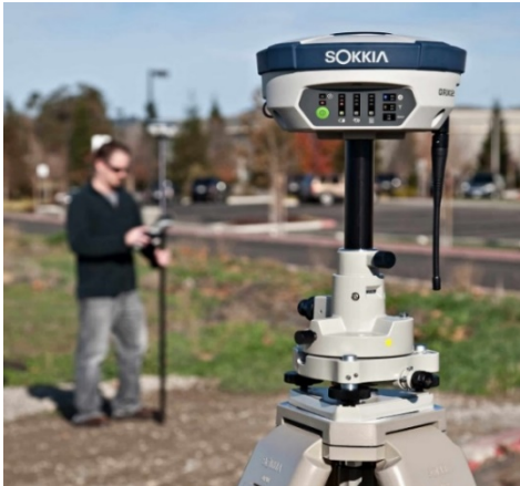
Gabimi ne pozicion planimetrik \pm 2\text{-}3\text{cm} Gabimi ne kuote \pm 2\text{-}3\text{cm}
