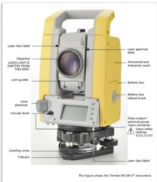
Gabimi gjatesor Ml = 2\text{mm} + 2\text{ppm} per brinje nga 400 – 1000 m Gabimi kendror mQ = 3''
