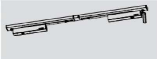
Dere antipanik 2-kanateshe TS 5000 L-ISM VPK Size EN 2-6, montim ne krah te kundert te menteshave, me sine. Mekanizem vetembylles per daljet e emergjences
