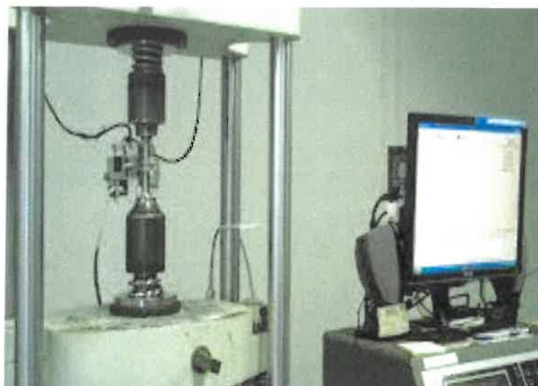
Fig. Procesi i testimit te hekurit ne presen hidraulike
