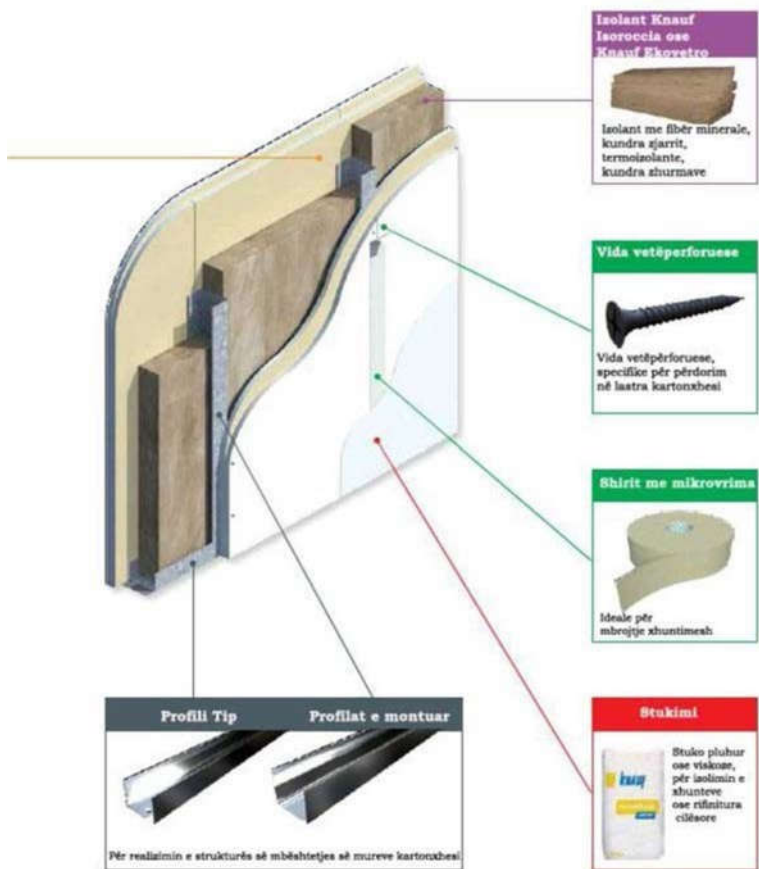
Fig. 9 detaje te montimit te kartonxhesit
