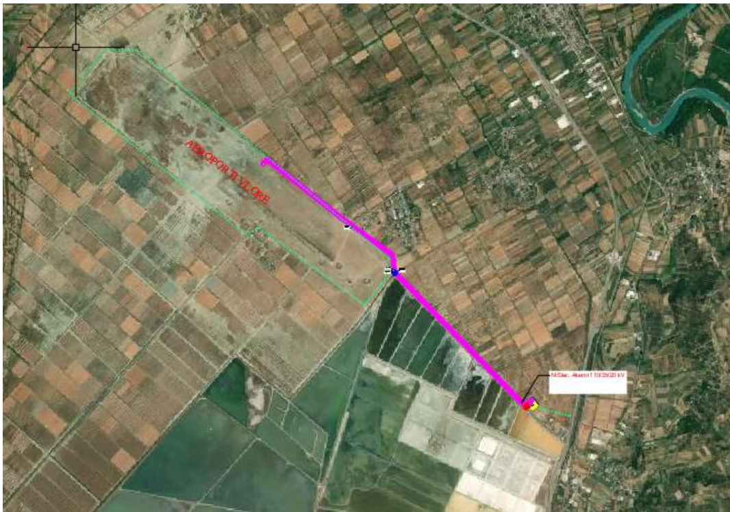
Figura 1: Traseja e linjes kabllore 35kV N.Stacion Akerni – Aeroporti i Vlorës.
