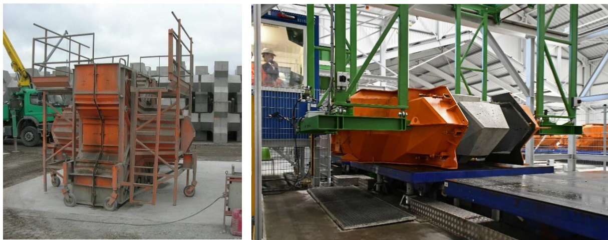
Figura 1-3: Kallëpet e Xbloc dhe XblocPlus
