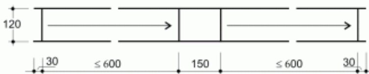
Figura 11-6: Dimensionet optimale në rampat e jashtme
