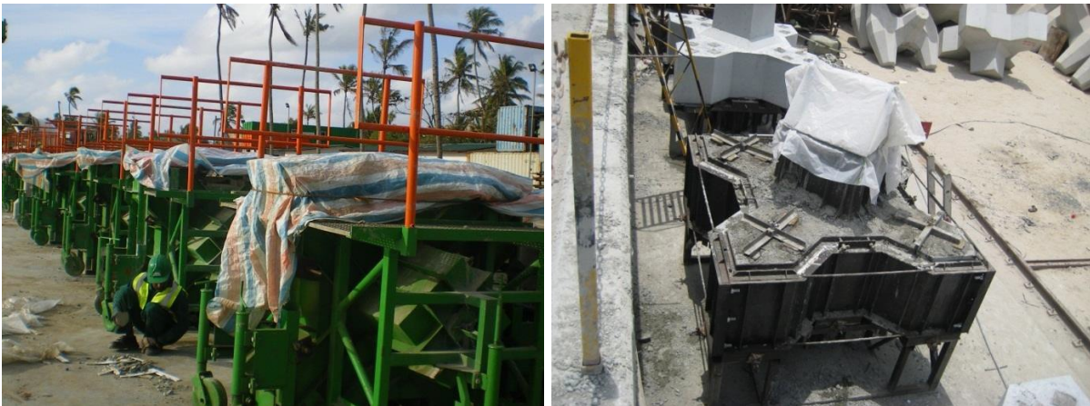
Figura 5-4: Mbrojtja e pjesëve të ekspozuara nga mbulesat plastike (kallëpi vertikal i majtë, kallëpi horizontal i djathtë)
