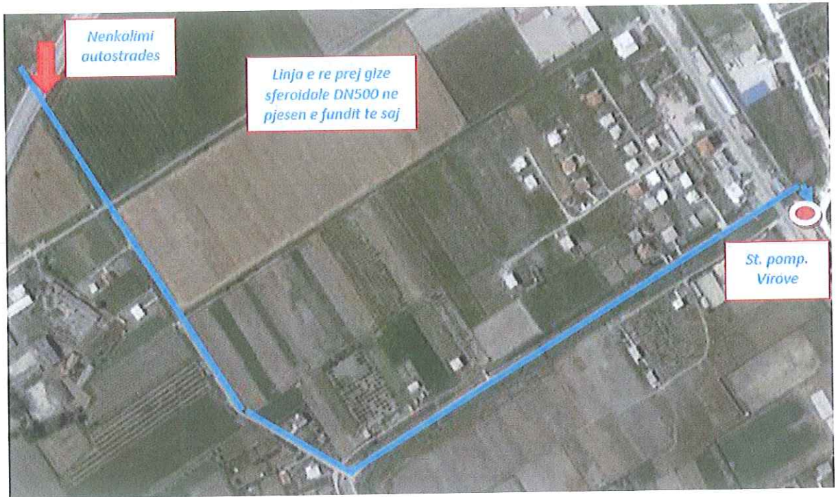
Figure 4-3 Pjesa e fundit e trasese se tubacionit zevendesues prej glzesferoidale DN 500
