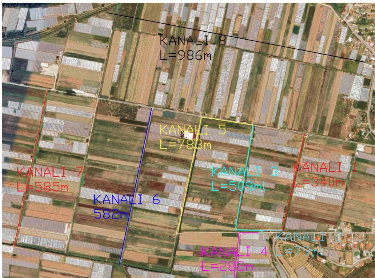
Fig-1. Horografia ( Kanalet me ngjyre pjese e projektit, kanalet qe do ndertohen )
