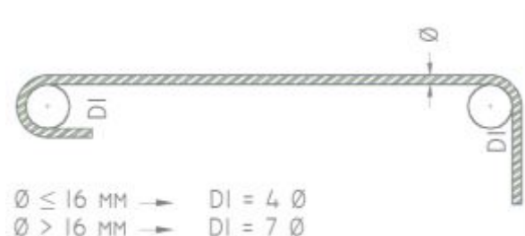
Fig. 1 – Zgjedhja e diametrit të mandrinës për kthimin e shufrave në varësi të diametrit të shufrave
